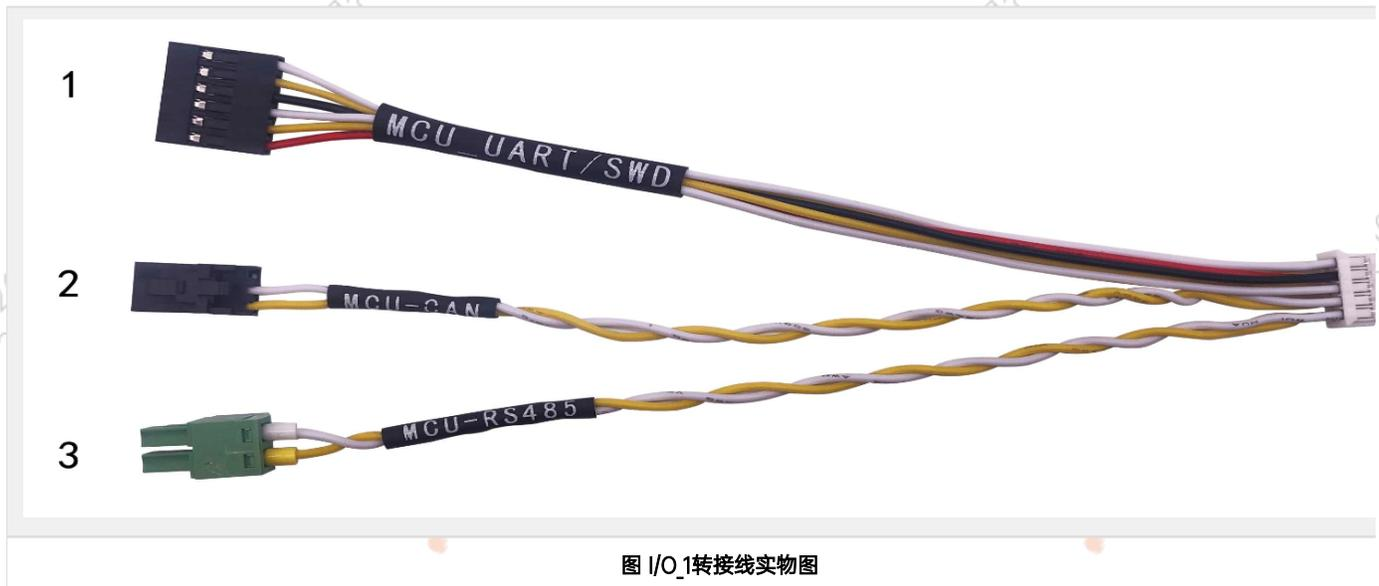
图 I/O\_1转接线实物图
